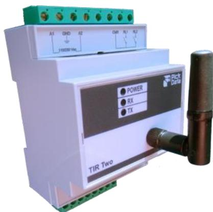
**TIR Two** (Temperature Inputs Relays) es un centralizador de señales digitales e impulsos. En tan sólo 4 módulos de carril DIN, el equipo posee 2 salidas de relé, 2 entradas digitales libres de tensión y 2 entradas analógicas para sondas de temperatura NTC/PTC.
